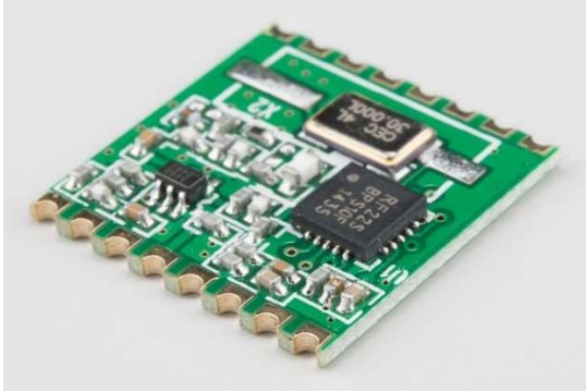
PCB-on-PCB met nis verbindingen
